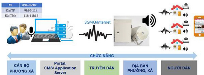
Mô hình truyền dẫn của hệ thống truyền thanh ứng dụng công nghệ thông tin - viễn thông
